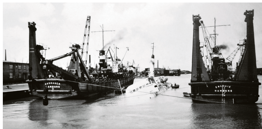
Die Bergungsschiffe AUSDAUER und ENERGIE versuchen die BREMERHAVEN aufzurich- ten. (Abb.: Slg. Focke)
