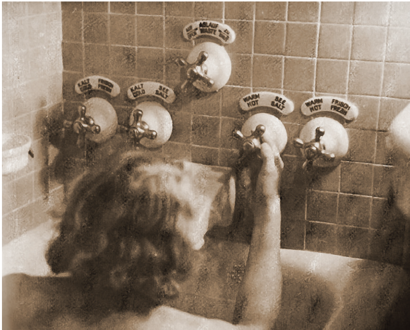
Bad auf der BREMEN IV, zu erkennen sind die vier Wasserhähne für die Auswahl, sofern man Süß- oder Salzwasser einlassen wollte (Foto: Erika Groth-Schmachtenberger)
